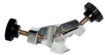
Doble nuez. Se usa para sujetar al soporte el aro de Bunsen, las pinzas, etc.
