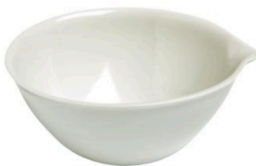
Cápsula de porcelana. Se usa cuando se quiere calentar o fundir sustancias sólidas o evaporar líquidos.
