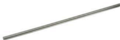
Varilla de vidrio. Se usa para mezclar o agitar sustancias; también en ciertas operaciones en que se necesita dejar caer, lenta y cuidadosamente, un líquido sobre otro evitando accidentes provocados por la reacción violenta entre ambos.
