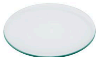
Vidrio de reloj. Sirve para pesar, calentar y transvasar pequeñas cantidades de sustancias sólidas.
