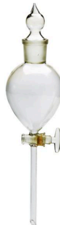
Embudo de decantación. Se utiliza para separar dos líquidos inmiscibles.
