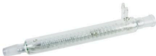
Refrigerante. Permite condensar los vapores del líquido o líquidos que intervienen en la destilación.
