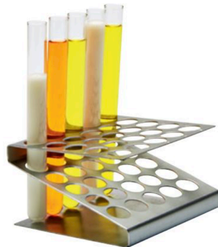
Tubos de ensayo. Sirven para disolver, calentar o hacer reaccionar pequeñas cantidades de sustancia.
