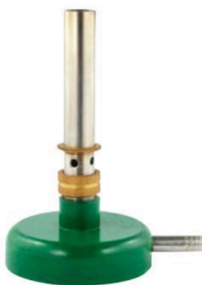
Mechero de Bunsen. Se usa como fuente de calor.
