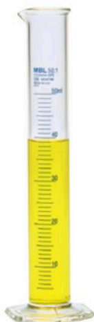
Probeta graduada. Se emplea para medir volúmenes de líquidos.
