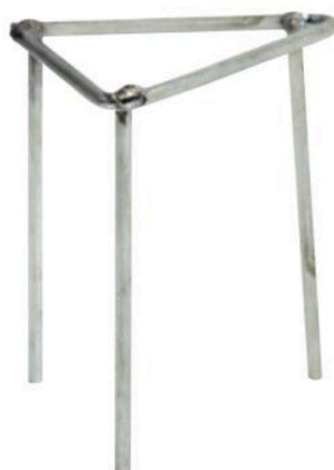
Trípode. Variación del aro de Bunsen, con la misma utilidad, pero con tres patas para colocarlo sobre la mesa del laboratorio.
