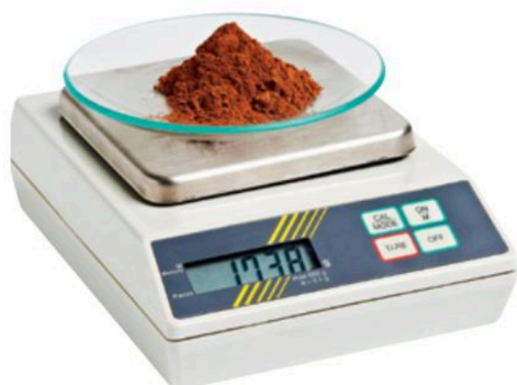
Balanza de precisión. Se emplea para medir masas de sustancias sólidas.
