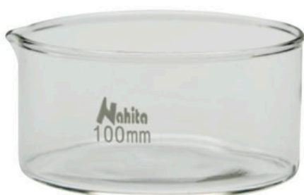
Cristalizador. Se usa para evaporar sustancias.
