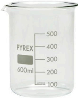
Vaso de precipitados. En él se pueden preparar, disolver o calentar sustancias.
