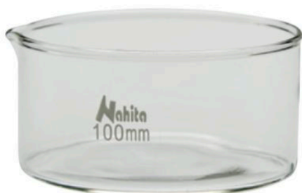
Cristalizador. Se usa para evaporar sustancias.
