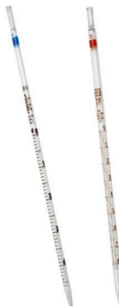
Pipetas graduadas. Se utilizan para medir un volumen exacto de líquido, con bastante precisión, y transferirlo de un recipiente a otro.
