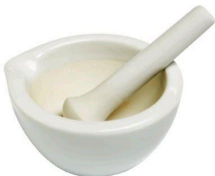
Mortero. Se utiliza para machacar y/o triturar sustancias sólidas.
