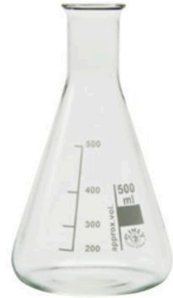
Erlenmeyer. Se usa fundamentalmente en valoraciones, aunque se puede utilizar también para calentar, recoger destilados, filtrados, etc.
