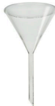
Embudo. Con él se transvasan líquidos de un recipiente a otro, evitando que se derrame líquido; también se utiliza mucho en operaciones de filtración.
