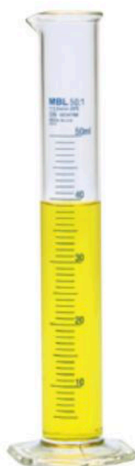
Probeta graduada. Se emplea para medir volúmenes de líquidos.
