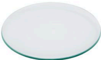
Vidrio de reloj. Sirve para pesar, calentar y transvasar pequeñas cantidades de sustancias sólidas.
