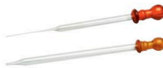
Pipetas gotero. Permiten transvasar pequeñas cantidades de líquido, de un recipiente a otro, cuando no es necesario realizar mediciones. Su función es la misma que la de un gotero.
