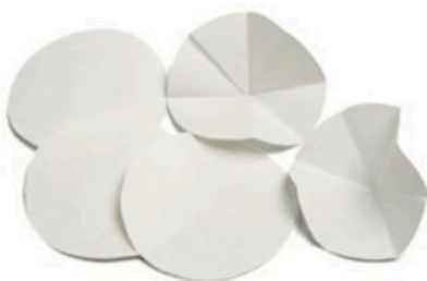
Papel de filtro. Se usa junto con un embudo en procesos de filtración.
