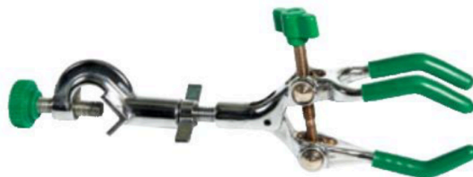
Pinza para bureta. Es necesaria para sujetar recipientes al soporte.
