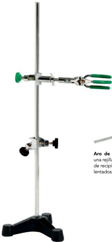
Pie y soporte. Sirven para, gracias a las pinzas y la nuez, sujetar los instrumentos con los que se está trabajando.
