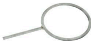
Aro de Bunsen. Se utiliza, con una rejilla sobre él, como soporte de recipientes que deben ser calentados con el mechero Bunsen.
