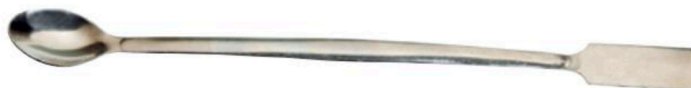
Espátula de combustión. Retira pequeñas cantidades de sustancia y las deposita en otro recipiente; también se pueden calentar en ella pequeñas cantidades de sustancia.
