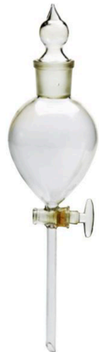
Embudo de decantación. Se utiliza para separar dos líquidos inmiscibles.
